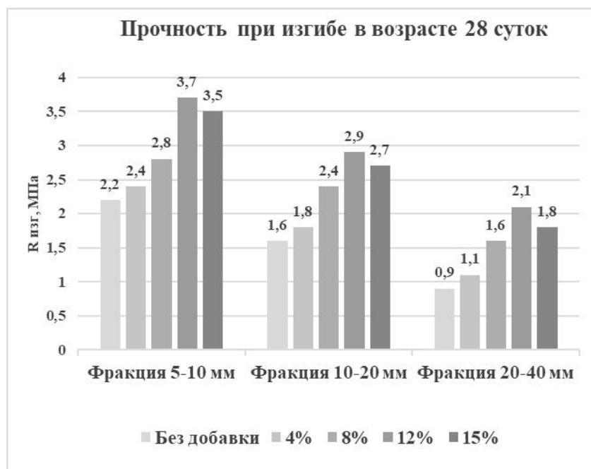
Рис. 2. Влияние добавки хризотилцементных отходов на прочность при изгибе крупнопористых бетонов на заполнителях разных фракций
